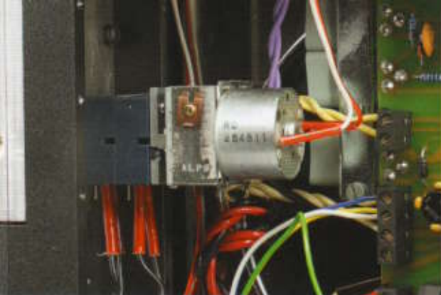
Unkritisch: Das Motorpoti regelt einen Arbeitswiderstand
