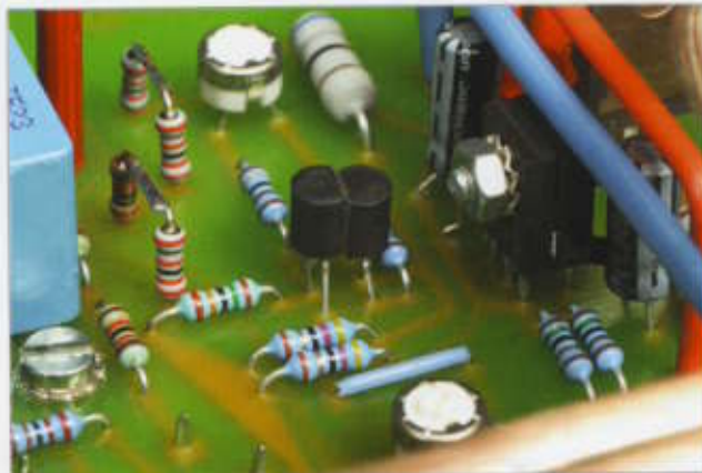
Zur Wärmekopplung werden Transistoren zusammengeklebt
