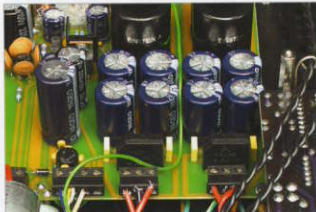
Für das Konzept sind mehrere unabhängige Netzteile nötig
