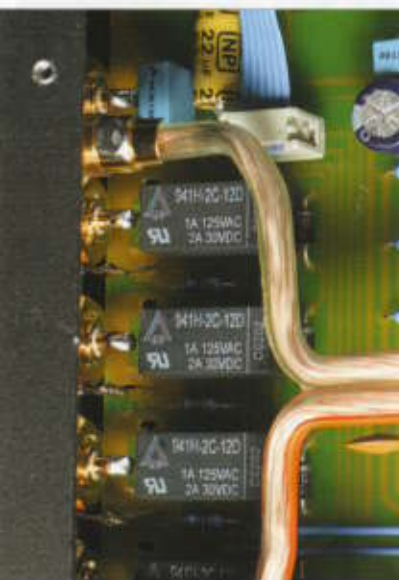
Alle Eingangswahl-Relais trennen oder schließen auch die Marcelleitungen
