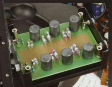
Oben: Traut sich sonst keiner: Das Analogfilter des „Last Record Player“ ist eine rein passive Spulen-Kondensatorlösung
