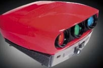
Crystal View 1 имеет самую совершенную в мире систему оптической проекции. Оснащенный тремя линзами/трубками жидкостного наполнения, CV1 достигает соотношения контрастности более 10000:1, отображая на экране абсолютные уровни белого и черного и исключительную детализацию на всех уровнях яркости.
