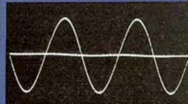
Forme du signal sinusoïdal à 1 kHz/30 W. Résultats : Le taux de distorsion par harmoniques est très faible, soit 0,0048 % seulement, avec un résidu harmonique noyé dans le bruit.
