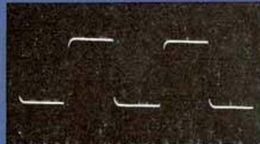
Forme du signal carré à 20 kHz/20 W. Résultats : Le temps de montée sur signal carré à 10 kHz est de 1,5 µs seulement. Le signal est très propre, supérieur à celui de la version intégrée IN 100.
