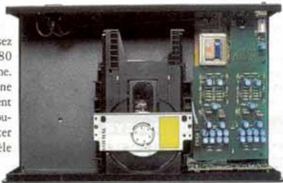
La jolie carte de droite est entièrement réalisée en composants discrets.
